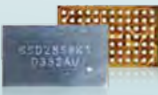
MIPI Display Interface Controller IC for displays of WQXGA resolution 適用於 WQXGA 顯示的 MIPI 顯示器 介面控制器 IC
