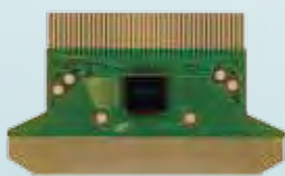
132 Segment Color Bistable Display Driver IC SSD1627 支持彩色132段碼式雙穩態顯示驅動器IC SSD1627
